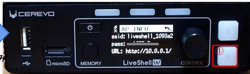
表示されている設定でPCの無線LANの設定を行ったら、①「B」ボタンを2回押して「NETWORK」に戻る
